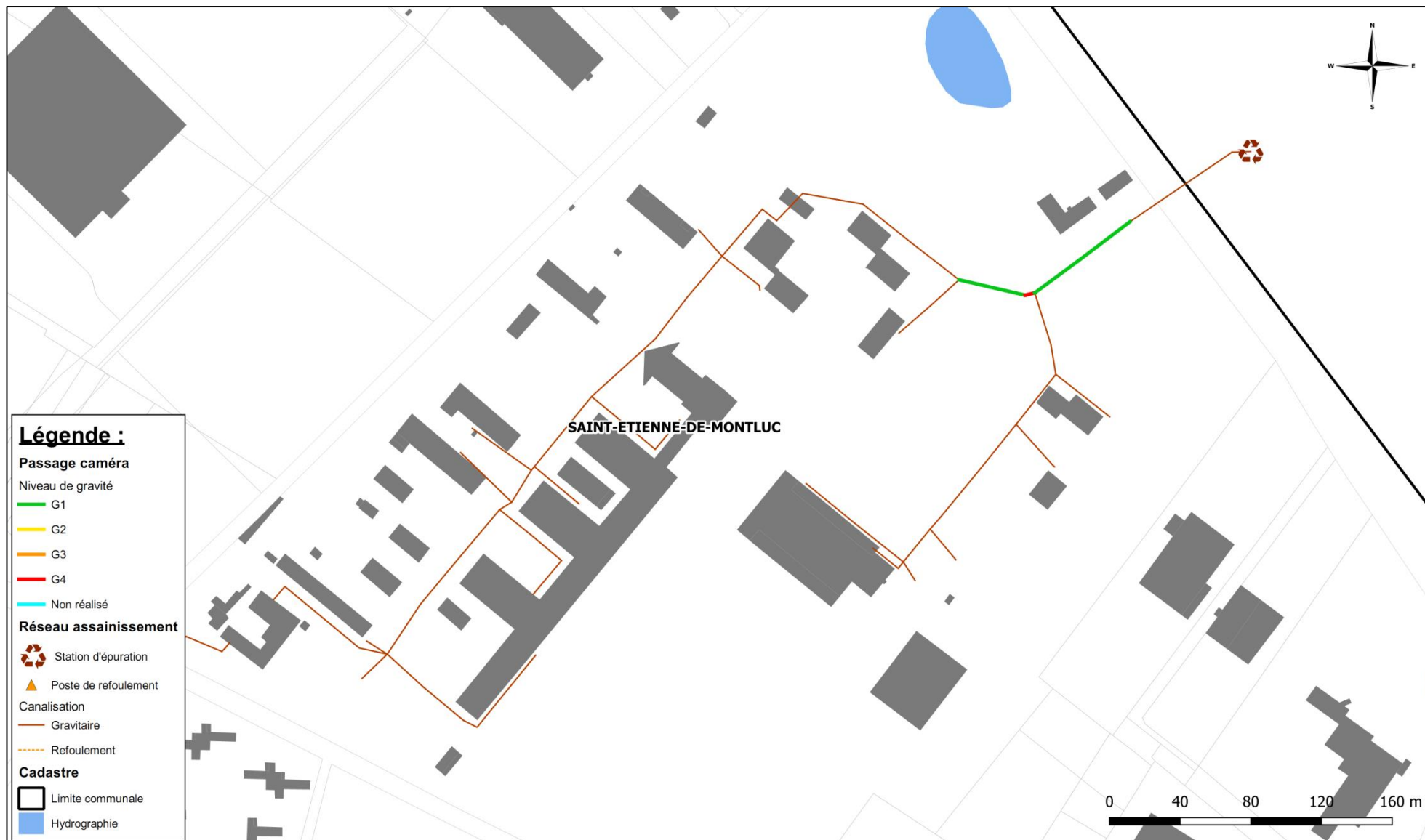
Figure 81 : Localisation des désordres selon le critère Attaque Chimique sur le système de l'École du gaz à Saint-Étienne-de-Montluc
