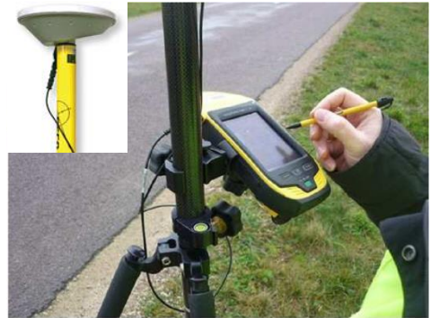
Figure 26 : Matériel utilisé pour le repérage GPS
