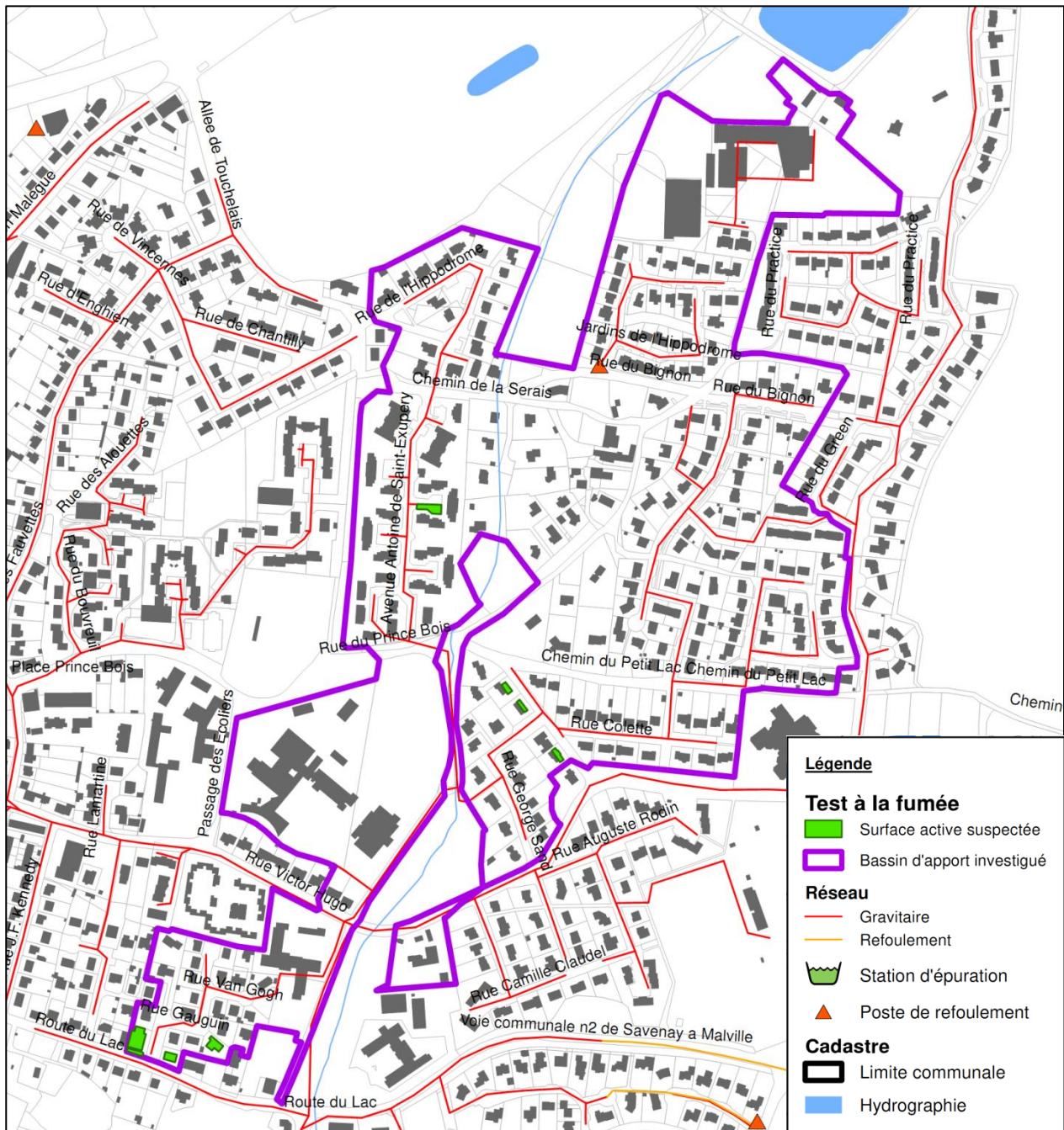
Figure 104 : Localisation des surfaces imperméabilisées ayant réagi positivement aux tests à la fumée sur le bassin BA3 à Savenay
