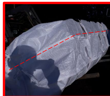
Emballage dépassant la limite de remplissage
